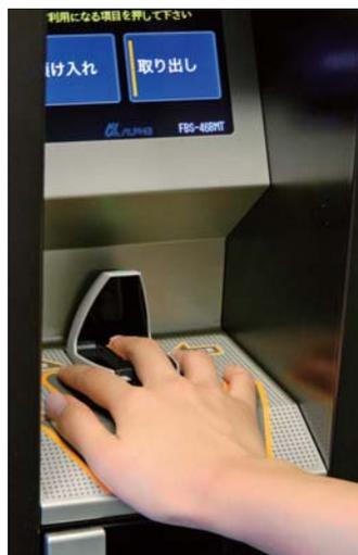
指静脈認証時の姿勢は日本人の身長の方の 5 パーセントから 95 パーセントの方の目線、肘や手首の角度などから最適な画面の位置、指静脈装置の配置を決定し製品に反映させています。
